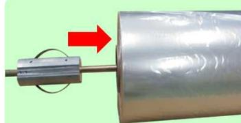
フィルムシャフトを差し込むだけでフィルムを簡単に固定できます。
